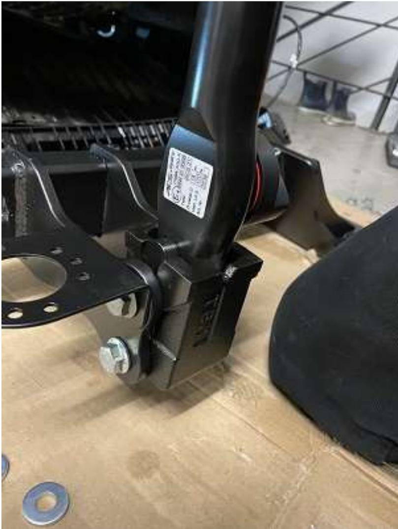
Nun die Kupplungsaufnahme in den Träger einschrauben. Zuerst etwas locker um das Ganze noch in Position zu bringen. Den Winkel der Steckdose habe ich im späteren Verlauf noch an der anderen Schraube weiter vor versetzt.
