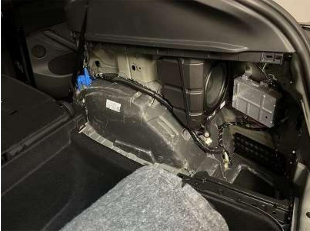
Alle Kabel nochmals ordentlich verlegen und mit Kabelbinder befestigen bevor die Verkleidung wieder montiert wird.
