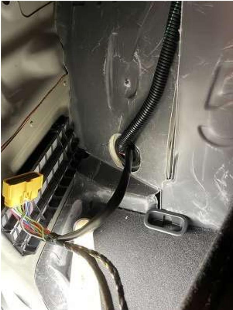
Beim linken hinteren Radlauf geht bereits ein Kabelstrang durch eine Gummitülle nach außen. Normalerweise schneidet man einen Schlitz in die Gummitülle und fädelt den AHK Kabelsatz durch. Ich habe es jedoch geschafft das AHK Kabel zusätzlich mit dem anderen Kabel durch die vorhandene Öffnung zu fädeln.
