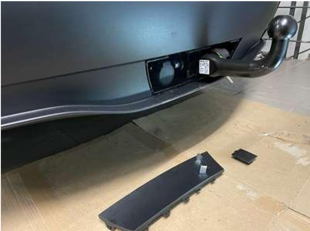
Fertig montiert. Das kleine silberne Teil am Deckel ist meine Abziehhilfe mit der ich unter den Schlitz seitlich rein kann zum besseren Abziehen des Deckels.
