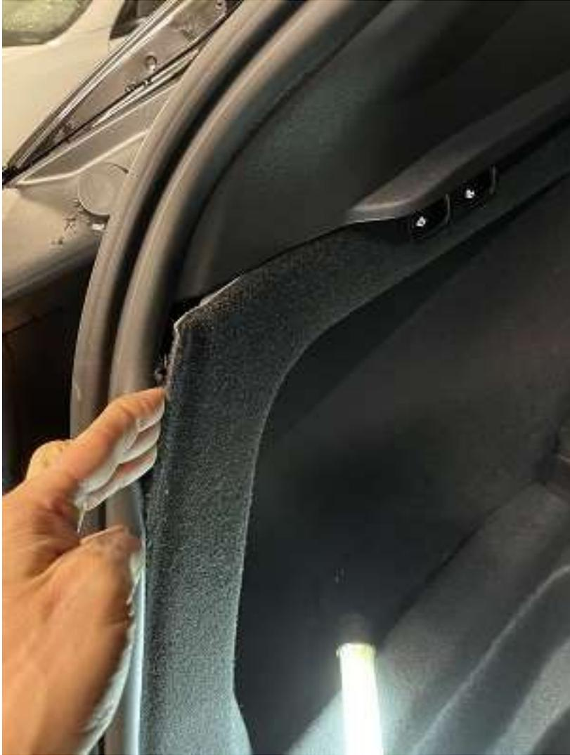
Kofferraum Gummi etwas anheben um Seitenverkleidung Clips zu lösen.
