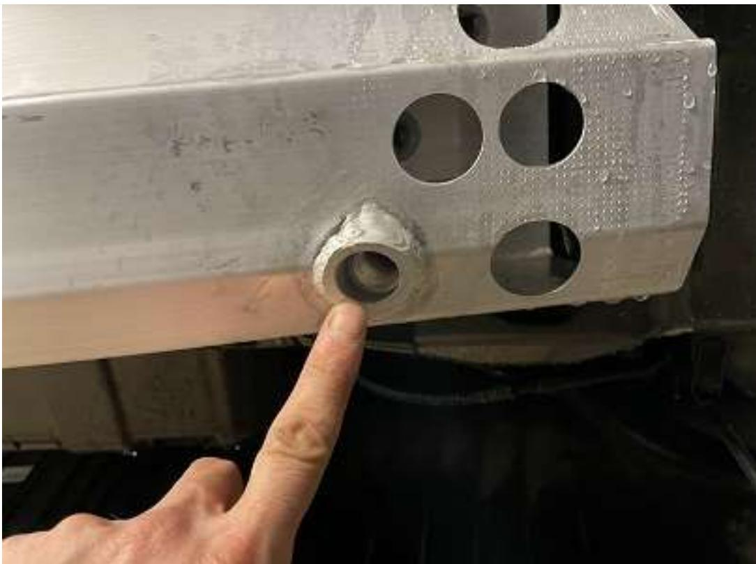
Der AHK-Träger hat leider kein Gewinde mehr für den Abschlepphaken.
