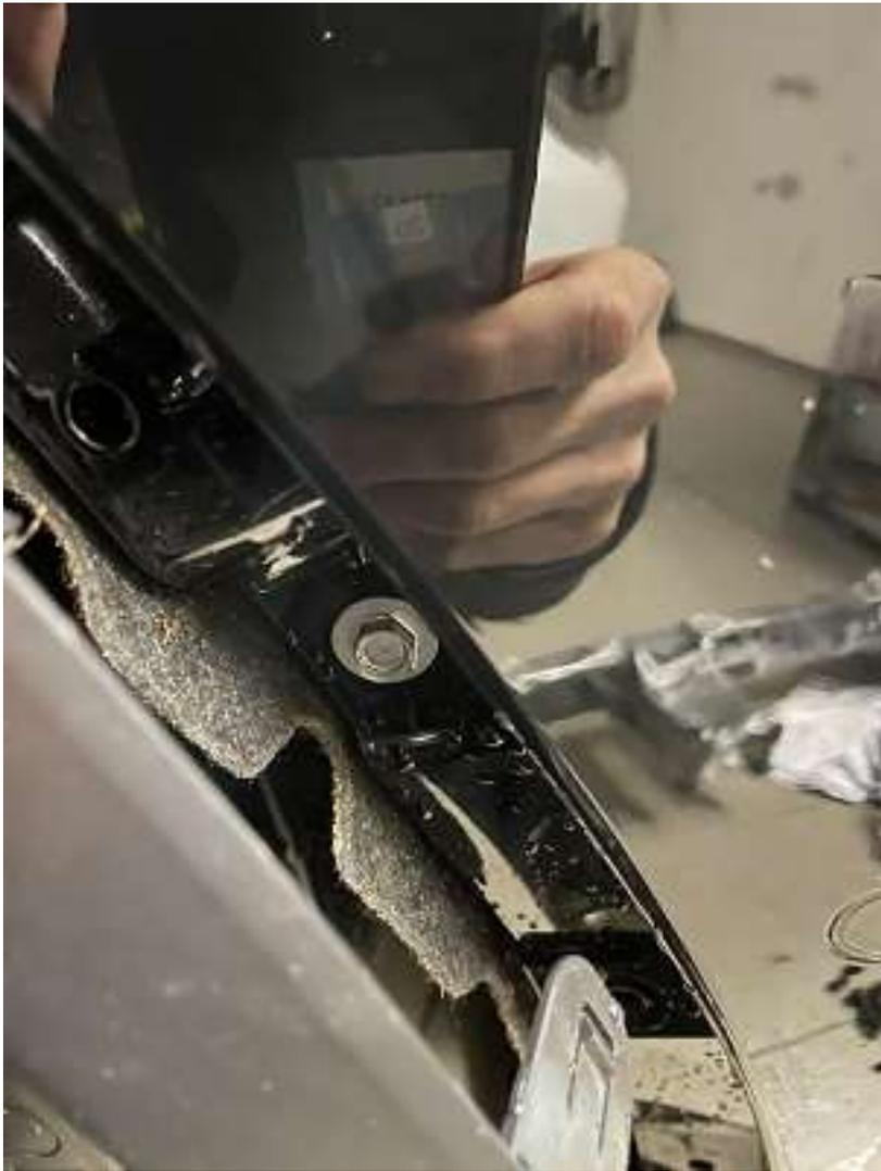
Hinter der Plastik Radhausabdeckung die Schraube der Stoßstangenbefestigung lösen (li+re).
