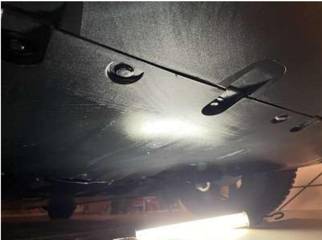
Mehrere Clips und Schrauben unter der Stoßstangenverkleidung entfernen. Tipp: Am besten in richtiger Reihenfolge an sicheren Ort lagern damit man bei Zusammenbau gleich sieht wo was (Clip oder Schraube) wieder rein gehört.
