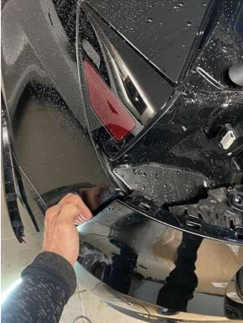
Nun die Stoßstange über Rastzapfen mit etwas Gefühl links und rechts aushebeln.
