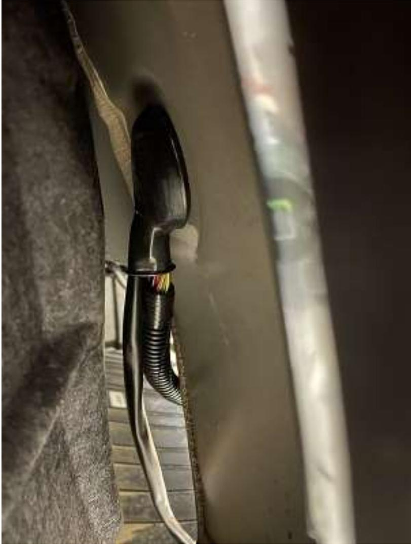
Hier Blick der Gummitülle mit beiden Kabelstangen aus Sicht äußerer Radlauf.
