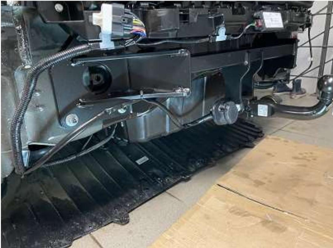
AHK Kabel mit Kabelbinder verlegen und Steckdose anhand beigelegten Belegungsplan verdrahten.
