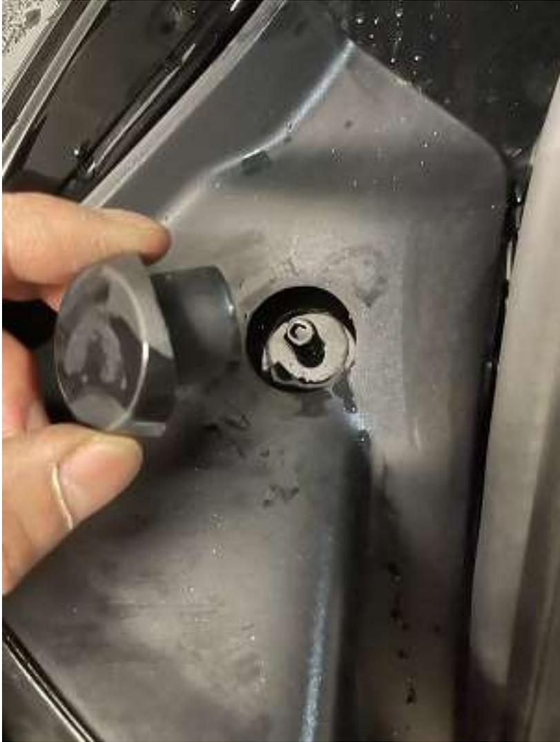
Gummipuffer oberhalb der Rückleuchten abziehen.
