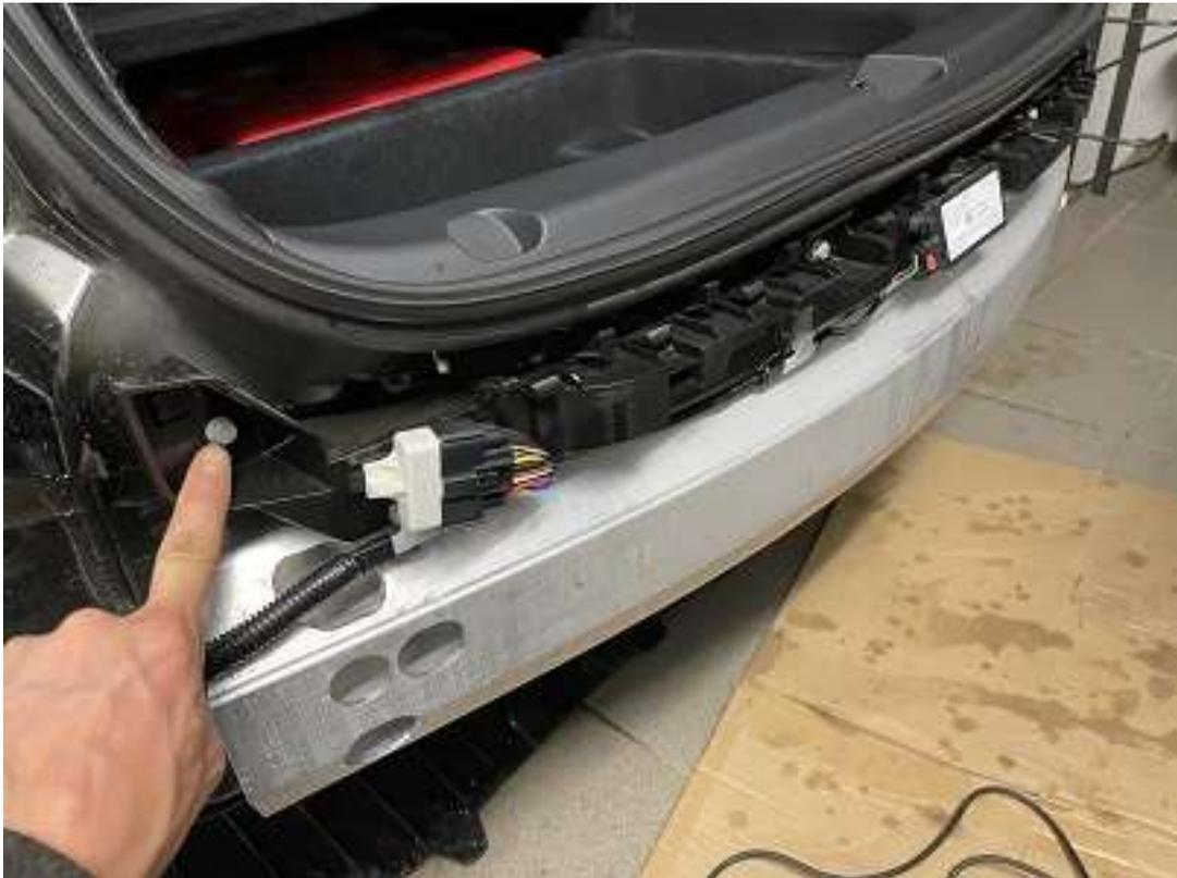
Nun diese Schrauben (li+re) der Plastikleiste lösen.
