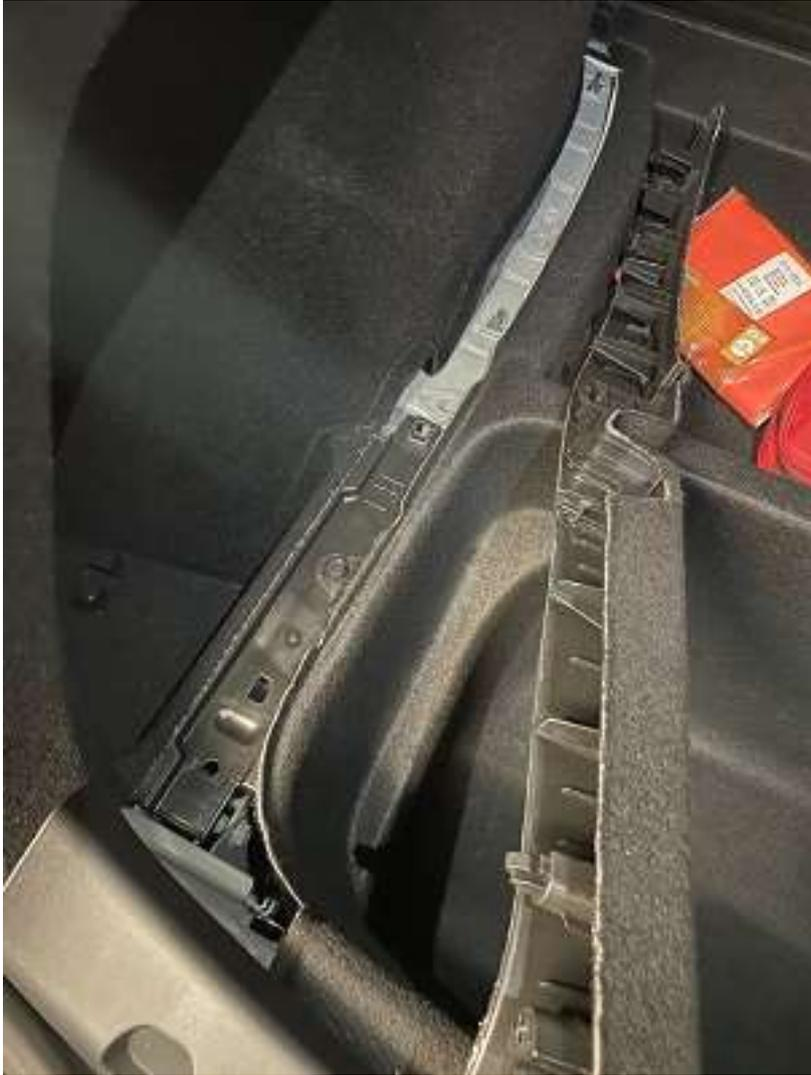
Für den Kabelsatz muß die Kofferraumverkleidung raus. Diese Trägerleisten sind links und rechts nur gesteckt. Nach oben abziehen und kurz prüfen ob die Clips noch in Position sind.
