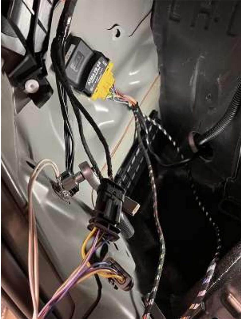
Mitgeliefertes AHK Steuergerät an linker Seitenwand innen befestigen und anstecken (gelber Stecker).
