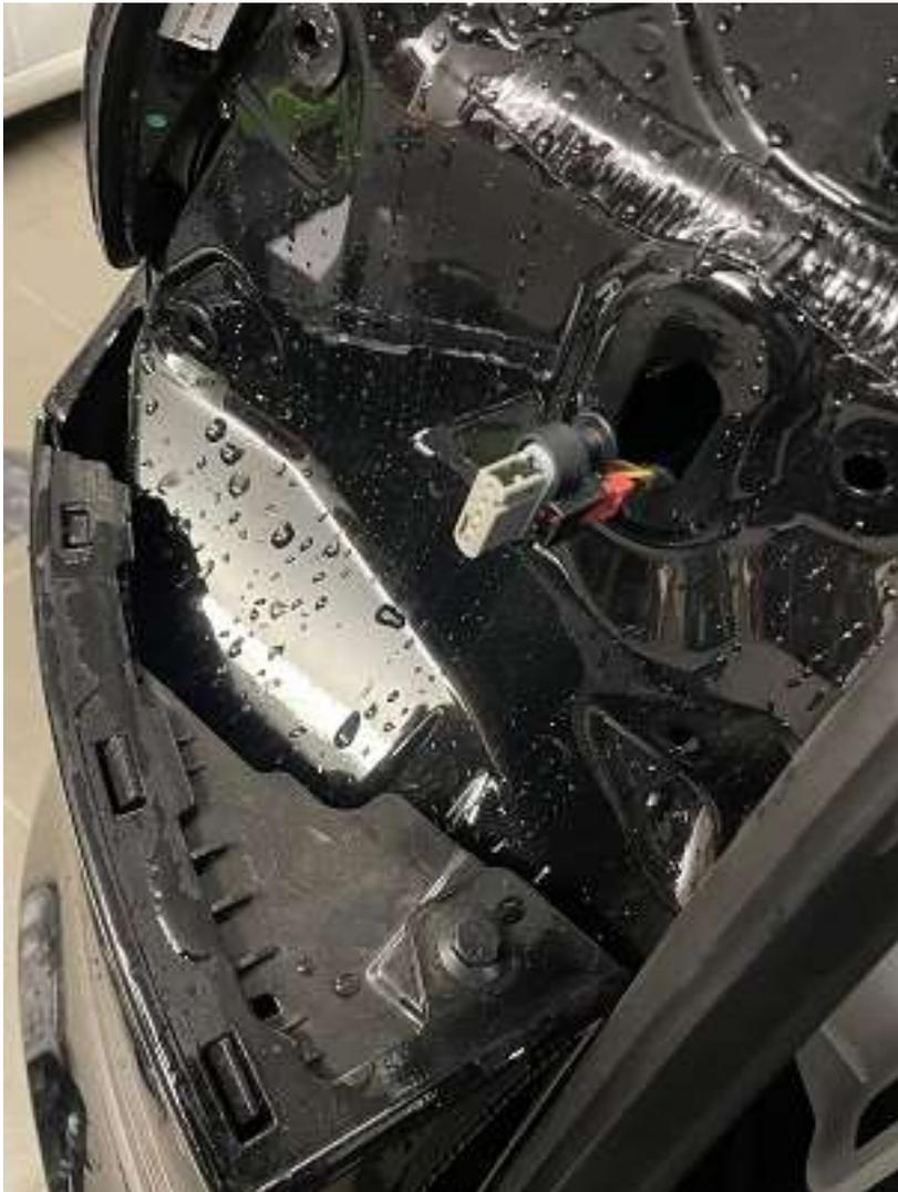
Unter der Leuchte ist jede Seite wieder eine Schraube der Stoßstange zu lösen.
