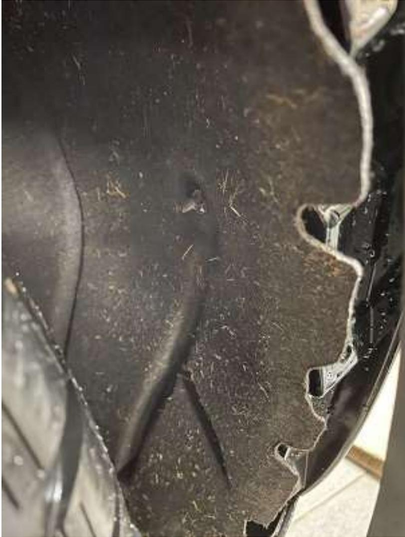
Abdeckung und die kleine „Mutter“ der Abdeckung hinten links lösen.
