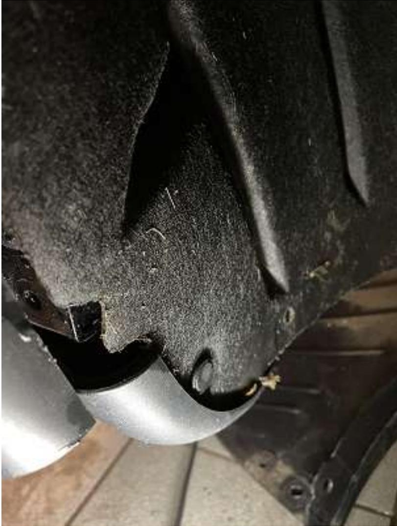
Wie bereits beschrieben auch Clips und Schraube im rechten Radhaus hinten lösen.
