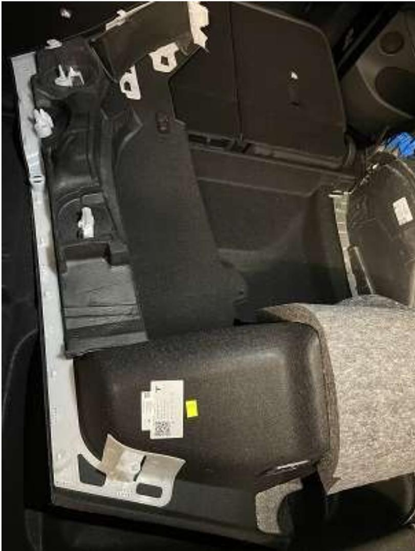
AHK Sicherung rein und dann Funktionstest bevor wieder zusammengebaut wird.
