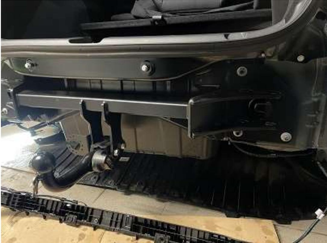
AHK Träger festschrauben in die Schraubaufnahmen des Alu-Prallträgers.
