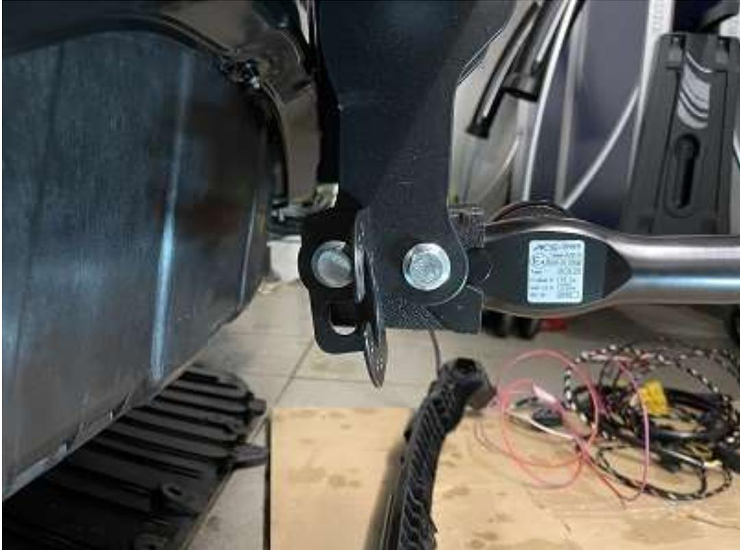
Nun nochmals den Halter der Steckdose versetzt. Diese Schraube noch etwas locker gelassen um später den Winkel der Dose noch anzupassen.
