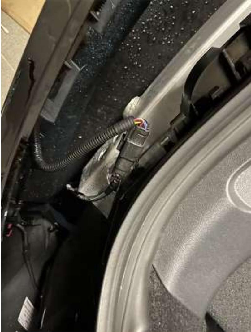
Vor dem Abnehmen PDC-Steckverbindung rechts lösen.
