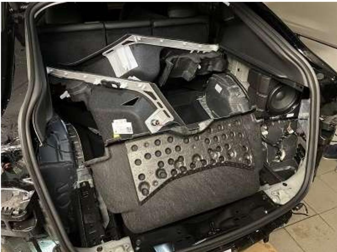
Verkleidung der Bodenwanne raus. Teilweise li+re noch ein Clips zu lösen aber das sieht man gleich.
