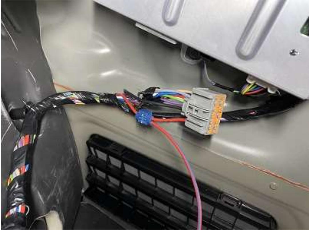
Stromversorgung an Pos 6 des 12-poligen grauen Steckers (rotes Kabel) abgreifen. Danach grauer Stecker wieder einstecken.
