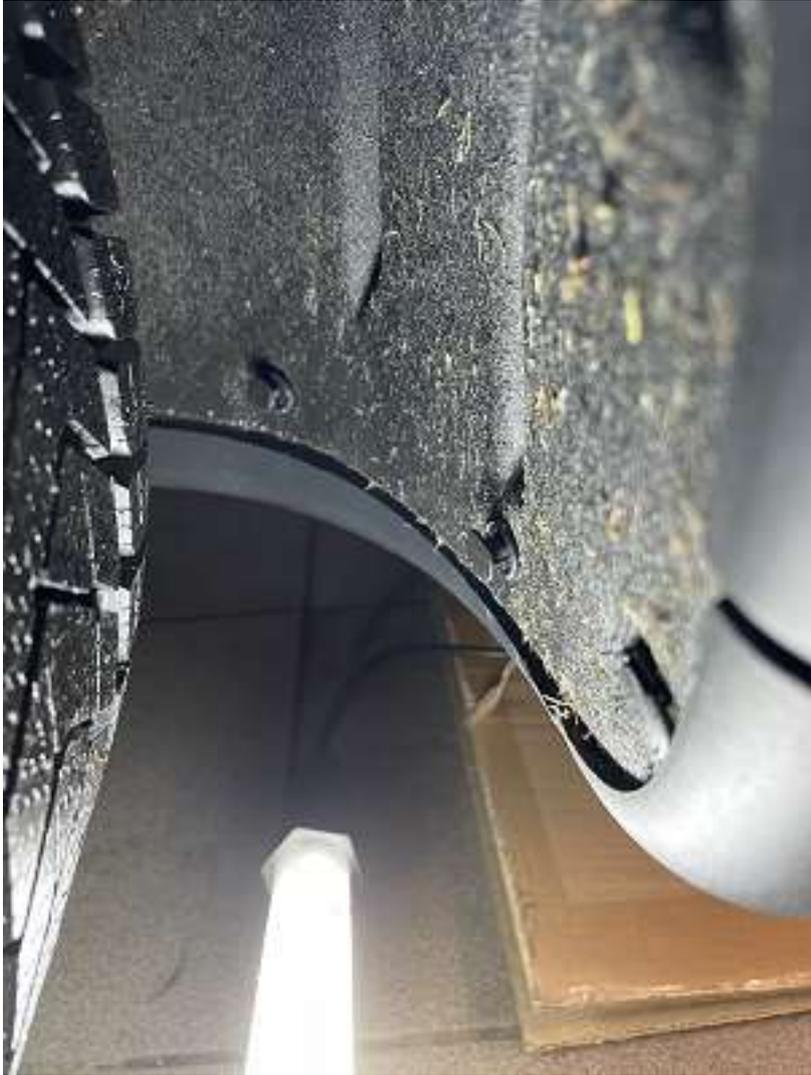
Diese 3 Clips in Radhausschale li+re entfernen.
