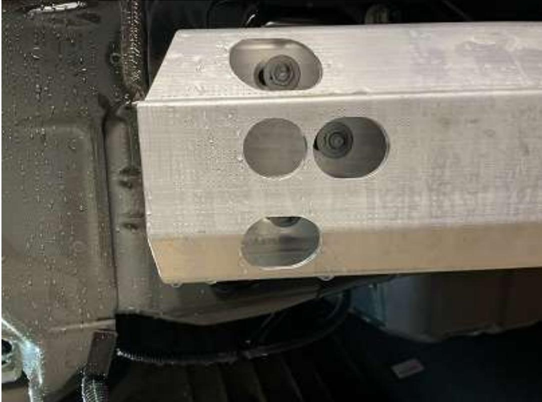
Dieser Aluträger muß nun ab und wird durch den AHK Träger ersetzt.
